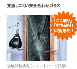
破壊試験状況(ショットバック試験)画像提供 AGC株式会社
